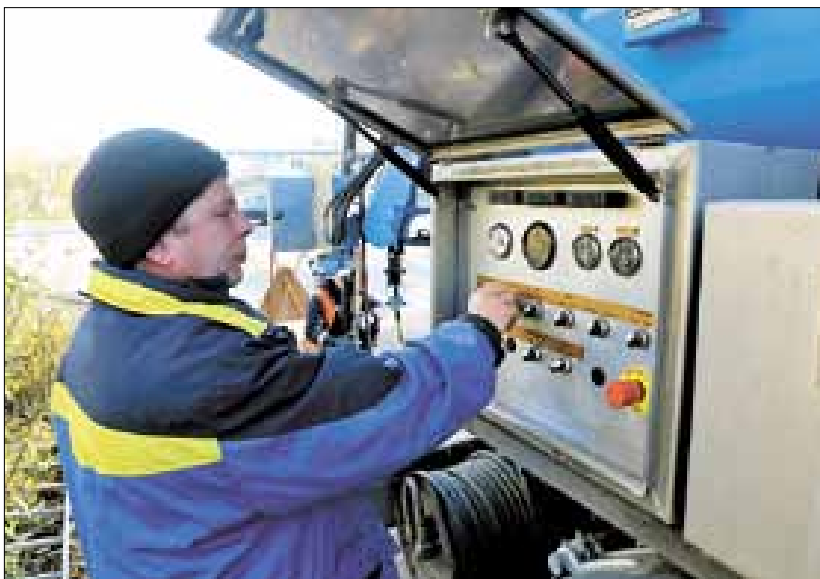
■ Пульт управления каналопромывочной машиной на базе МАЗ
